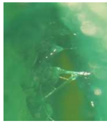
Рис. 7. Вытянутые волокна в стенке повреждения.
