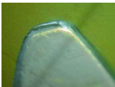
Рис. 1. Микрофотография затупленной зоны острия.
