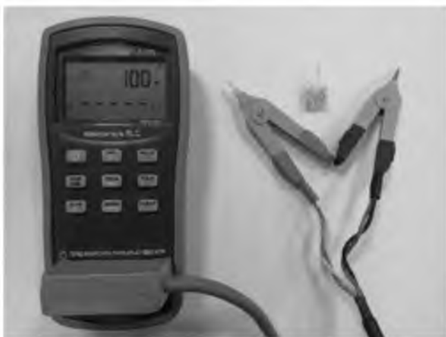
Рисунок 1. Измеритель параметров RLC АКПП-6109
