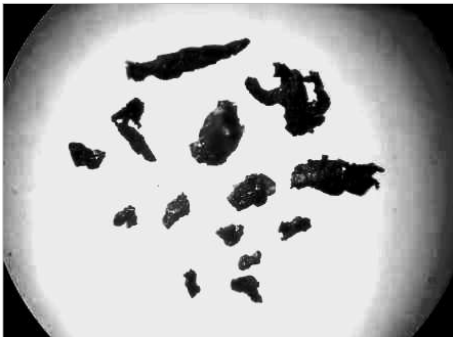
Рис. 5.7 Особенности микрочастиц резины, изъятых из зон следов протекторов от перекаtywания колесами различных автотранспортных средств без признаков износа следообразующей поверхности. Микрофотографирование с увеличением 32х.
