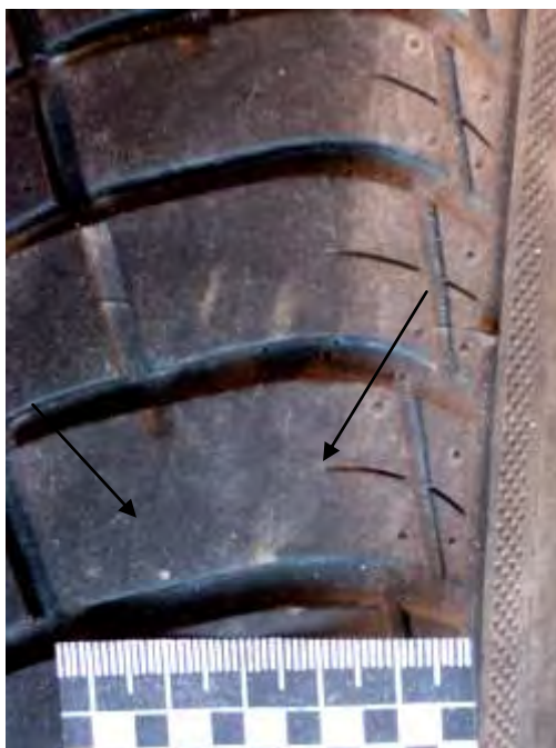
Рис. 2.2. Следы износа протектора автошины (показаны стрелками).
