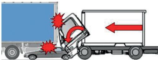
*Рис. 1.* Направление смещение фургона и кабины автомобиля Hyundai в момент столкновения с полуприцепом тягача Mercedes
