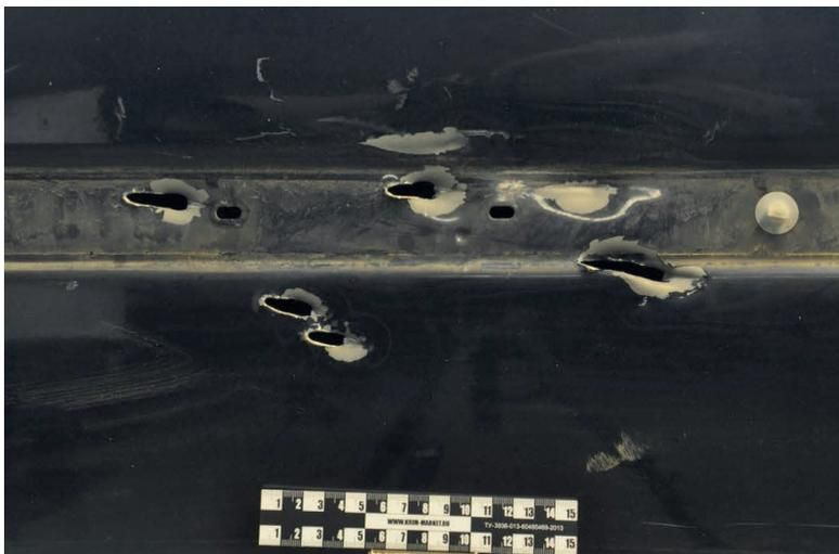
*Рис. 1.* Повреждения металла двери автомобиля при рикошете огнестрельного снаряда
