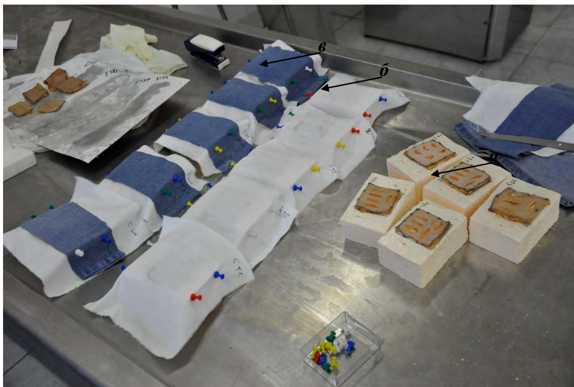
Рис. 2.5. Модели слоев ткани и кожного покрова на подложке перед экспериментом (а – препарат кожного покрова, б – один слой тонкой ткани, в – слой тонкой и слой толстой ткани)
