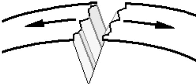
Рисунок 87. Разрыв поверхности ткани в результате растяжения, вызванного общей деформацией
