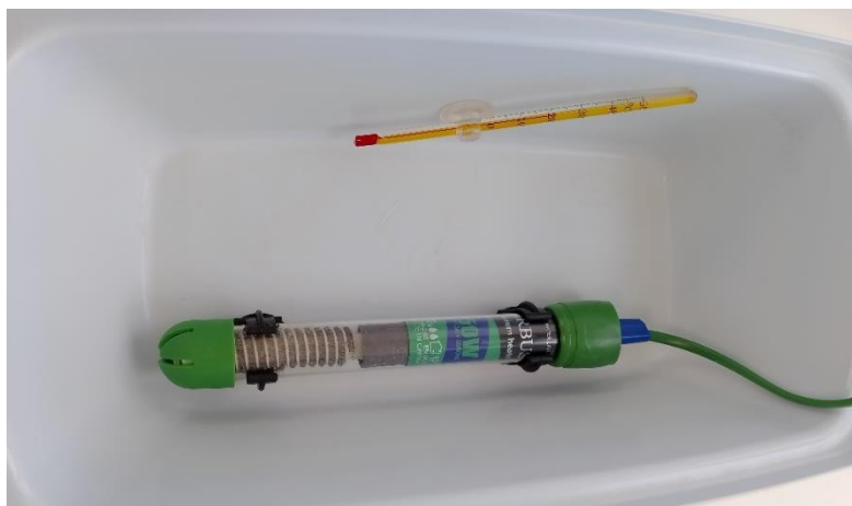
Рисунок 2.6. Общий вид емкости для содержания объектов в воде температурой 25-30°C и 31-40°C
